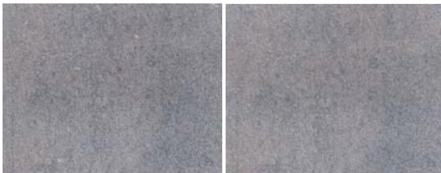
Obrázek 10: Otryskaný povrch [ Sa2^{1/2} ] před nanesením povrchové úpravy typ B a typ C [napravo].
